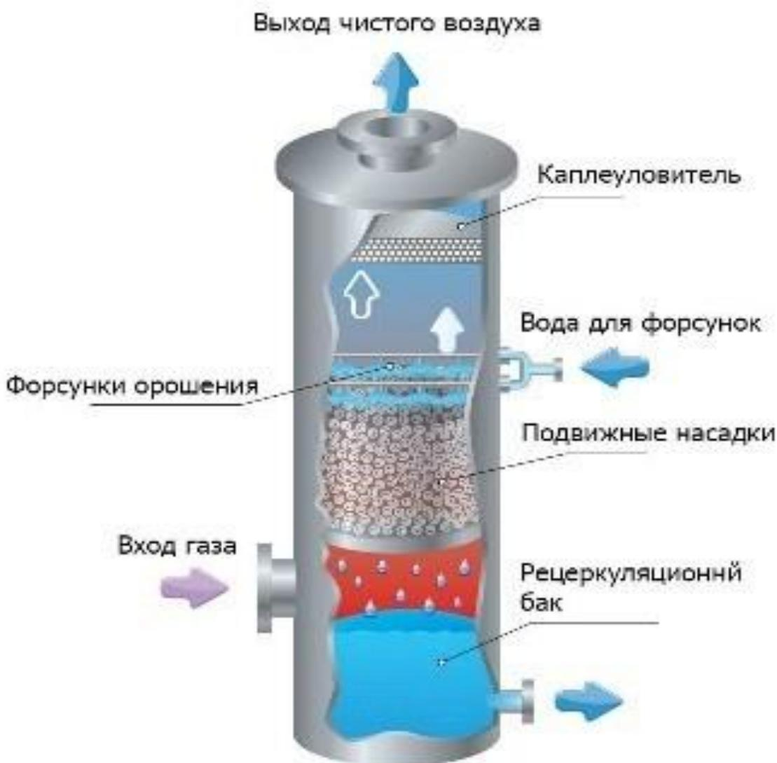
Рисунок 1.4 - Принцип работы Скруббера Вентури
